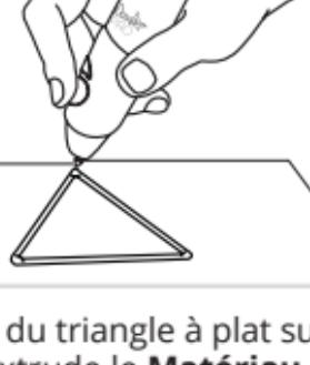
À l'aide du triangle à plat sur la page, extrude le **Matériaux** sur un angle du triangle jusqu'à obtenir une goutte. Assure-toi que celle-ci est arrimée dans le triangle avant de poursuivre.
