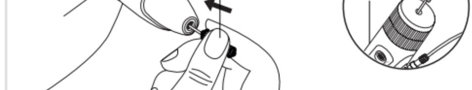
3B. Le filament est trop court pour être entraîné par la roue d'entraînement:
